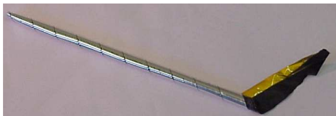
Abbildung 2.1: Die Strawtubes werden aus zwei Folien zweilagig gewickelt. Die schwarze innere Lage (Kathode) besteht aus leitfähigem Plastik (KaptonXC), die äußere aus Aluminium-Kapton-Laminat.
