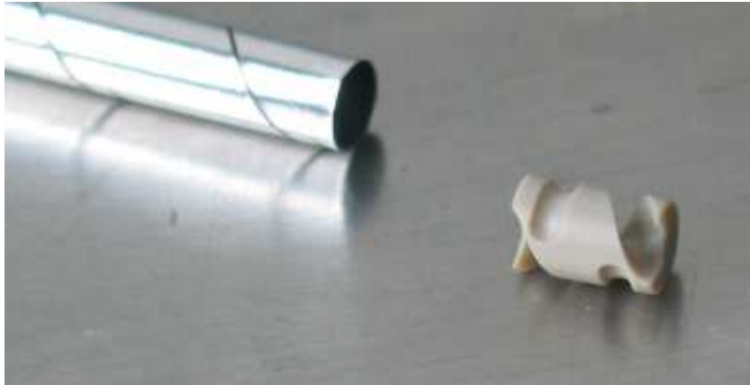
Abbildung 2.7: Mit Twistern wie diesen werden die Strawtubes bestückt. Sie halten den Anodendraht in der Mitte vom Strawtube. Ein Twister ist 7 mm lang.
