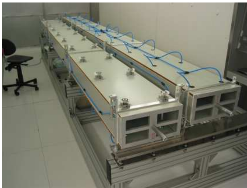
Abbildung 2.17: Zwei Tragevorrichtungen für jeweils eine Modulhälfte (aufgelegt auf festem Unterbau). Die Modulplatte wird mit zwanzig höhenverstellbaren Saugern angesaugt. Die Saugköpfe sind auf der linken Vorrichtung zu sehen. Während der gesamten Produktionsdauer bleiben die Modulplatten auf Position, auch wenn die Tragevorrichtungen umgedreht werden, wie die rechts im Bild.
