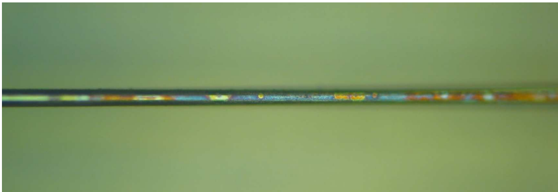
Abbildung 7.18: Bestrahlter Bereich des Anodendrahtes aus Kanal 3b. Die Verfärbungen auf der Drahtoberfläche sind charakteristisch für die bestrahlten Anodendrahte aus Doppelkammer 3.
