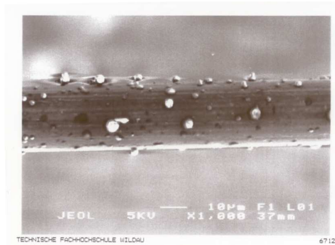
Abbildung 6.25: Unbestrahlter Drahtabschnitt (Kanal 1b, Position 340) betrieben in trockenem Ar/CO 2 /CF 4 . Auf dem Draht bildete sich eine isolierende Schicht, die Kohlenstoff und Sauerstoff enthält.
